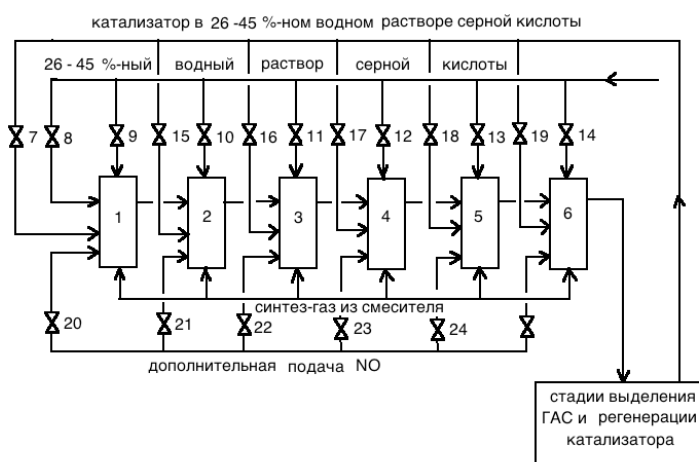
Рисунок 2 — Принципиальная технологическая схема получения ГАС.
