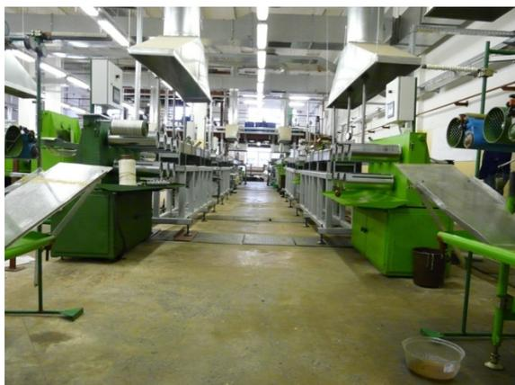
**Рисунок 1** — Линия получения СВМПЭ нити. Вид со стороны приемно-намоточной машины
