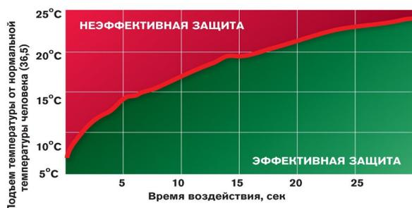
Рисунок 1 — Кривая роста температуры датчика в зависимости от времени
